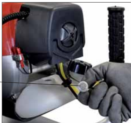
FIG. 7 FUEL FILTER CLEANING NETTOYAGE FILTRE ESSENCE REINIGUNG KRAFTSTOFFFILTER LIMPIEZA FILTRO MEZCLA PULIZIA DEL FILTRO MISCELA
