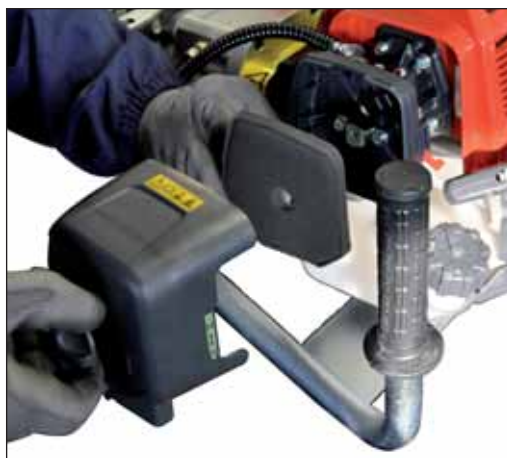
FIG. 8 AIR FILTER CLEANING NETTOYAGE FILTRE A AIR REINIGUNG LUFTFILTER LIMPIEZA FILTRO AIRE PULIZIA DEL FILTRO ARIA
